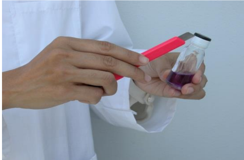
รูปที่ 3.4 ตัดแถบรัดปากขวดออกด้วยมีดหรือคัตเตอร์
