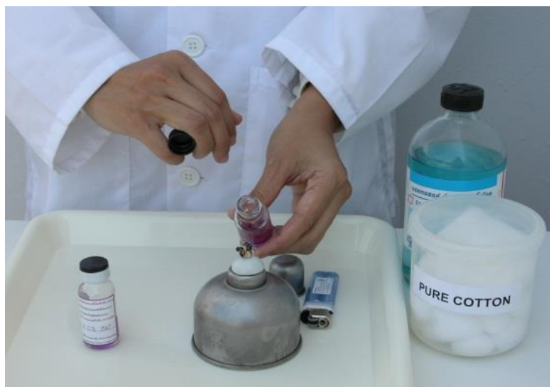
รูปที่ 3.12 ลนไฟที่ปากขวดเพื่อฆ่าเชื้อจุลินทรีย์
