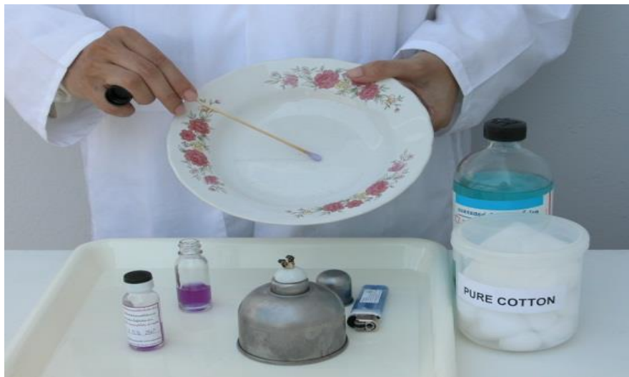
รูปที่ 3.10 ไม้พันสำลีมาป้ายภาชนะที่จะตรวจโดยหมุนไม้ช้าๆประมาณ4ตารางนิ้ว
