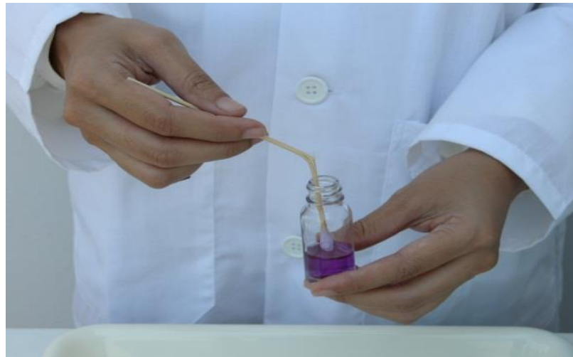
รูปที่ 3.11 พันสำลีจากที่ป้ายภาชนะเสร็จครบแล้วจุ่มลงในอาหารตรวจเชื้อ
