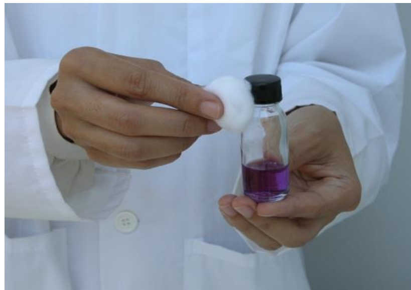
รูปที่ 3.3 ทำความสะอาดรอบฝาขวดและคอขวด
