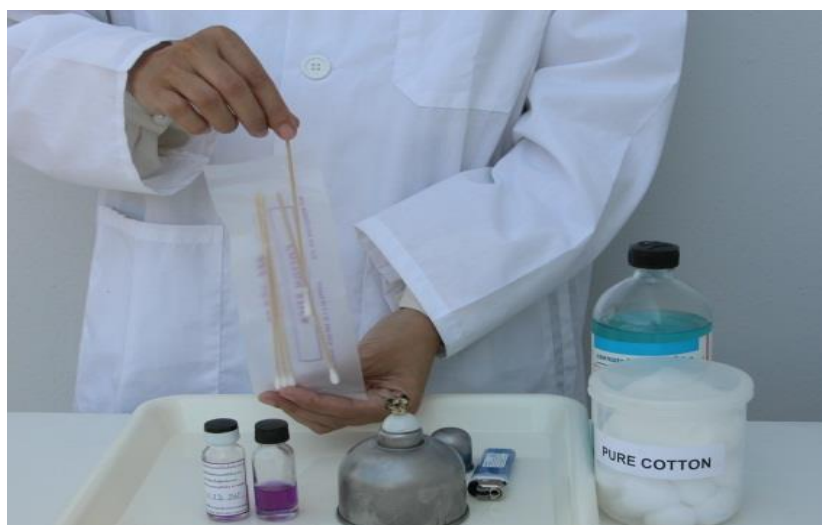
รูปที่ 3.8 เปิดห่อไม้พันสำลีที่ผ่านการฆ่าเชื้อ
