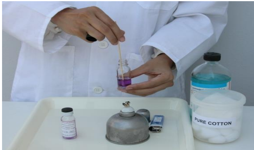
รูปที่ 3.9 ไม้พันสำลีจุ่มลงในอาหารตรวจเชื้อโคลิฟอร์มแบคทีเรียบดไม้กับข้างขวดแก้ว
