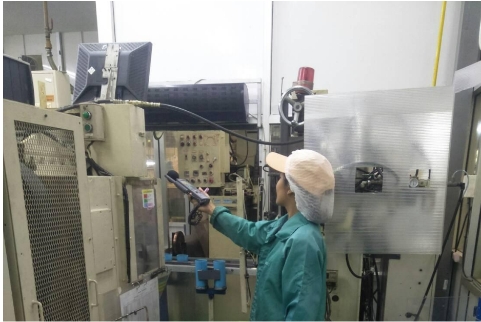
ภาพการตรวจวัดแสงสว่าง
