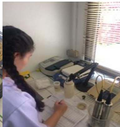
ภาพที่ 2 แสดงการวัดค่า pH , Temp , TDS, และ DO ณ ห้องปฏิบัติการสิ่งแวดล้อม
