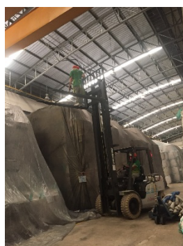
ภาพ 1-10 สำรวจจุดเสี่ยง พบการกระทำที่ต่ำกว่ามาตรฐาน เช่น ปฏิบัติงานไม่สอดคล้องกับกฎหมายการใช้งานรถยก
