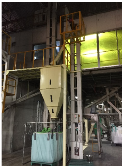
ภาพที่ 2-2 กระพ้อ B-2 มีความสูงประมาณ 6.6 เมตร และบริเวณโดยรอบ
