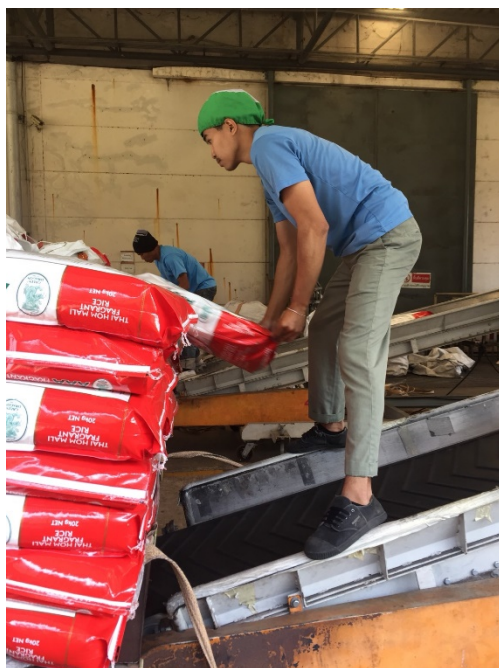
วิเคราะห์ความเสี่ยงจากงานโหลดสินค้าส่งออก พบความเสี่ยงพนักงานยืนบนสายพานลำเลียง
