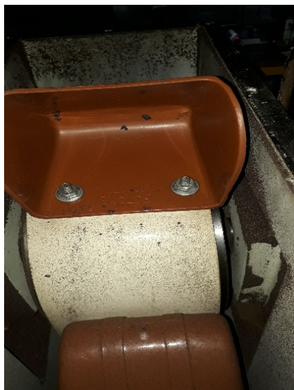
ภาพที่ 2-8 บริเวณจุดอับ ลมเป่าทำความสะอาดไม่ทั่วถึง
