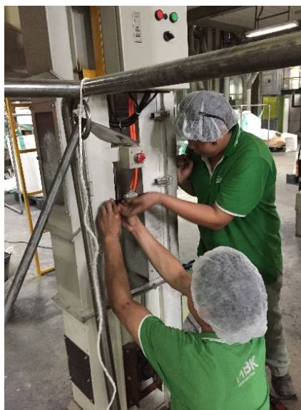
ภาพที่ 2-5 ต่อบอลวาล์วปิด - เปิด ที่บริเวณด้านล่างกระพ้อ
