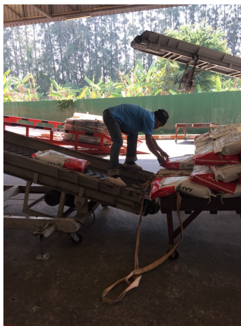
วิเคราะห์ความเสี่ยงจากงานโหลดสินค้าส่งออก พบความเสี่ยงพนักงานยืนบนสายพานลำเลียง
