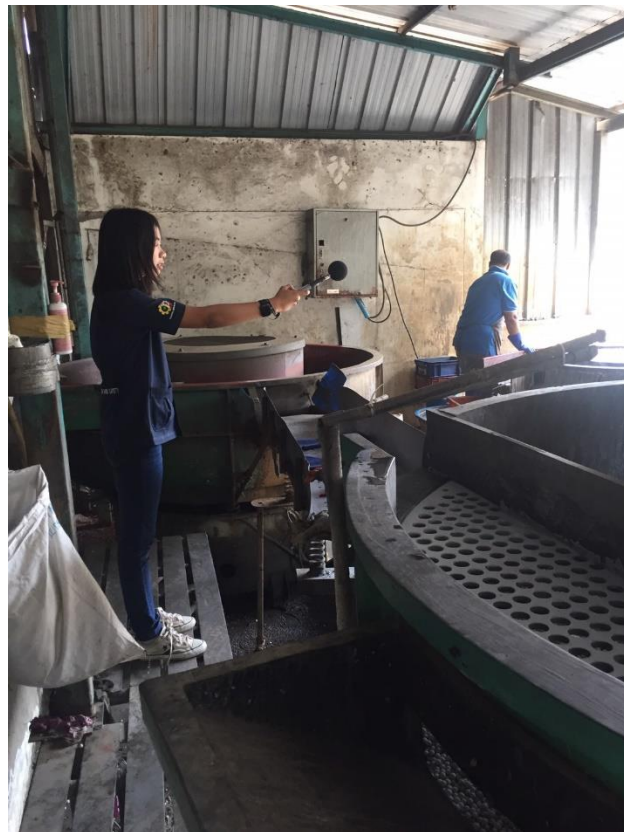
รูปการตรวจวัดเสียงแผนกขัดถึง
