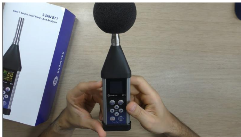
รูปที่ 2.1 เครื่องมือตรวจวัดเสียง (Sound Level meter) รุ่น SVANTEK 971
