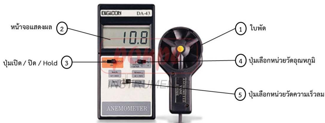
ภาพที่ 2-1 แสดงส่วนประกอบเครื่องตรวจวัดความเร็วลม
