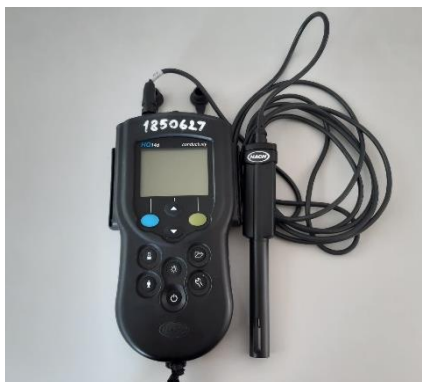
รูปที่ 2.10 เครื่องวัดค่าการนำไฟฟ้า (Conductivity Meter)
