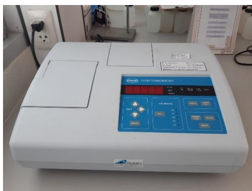
รูปที่ 2.8 เครื่องวัดความขุ่น (Turbidimeter)
