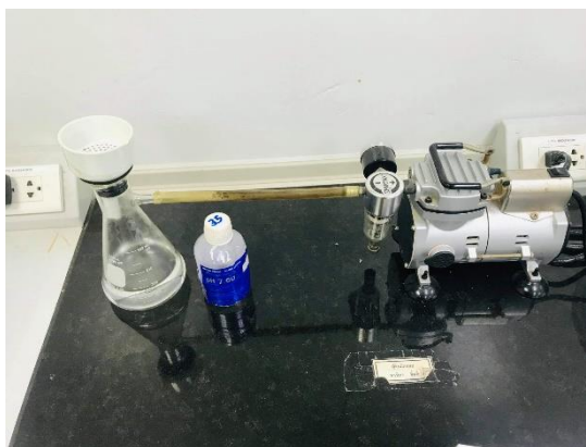
รูปที่ 8 อุปกรณ์ชุดกรอง เครื่องดูดอากาศ และกระดาษกรองใยแก้ว(GF/C)
