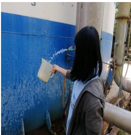
ภาพที่ 2.6 เก็บน้ำดิบจากถังที่ 3
