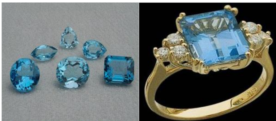
ภาพที่ 2.14 ตัวอย่างอัญมณีฉายรังสีด้วยเครื่องปฏิกรณ์นิวเคลียร์วิจัย ฉายรังสีนอกแกนเครื่อง (นิวตรอนพลังงานสูง) บวกด้วยการฉายด้วยเครื่องเร่งอิเล็กตรอนสำหรับ สีน้ำเงินสวิส (Swiss blue Topaz)
