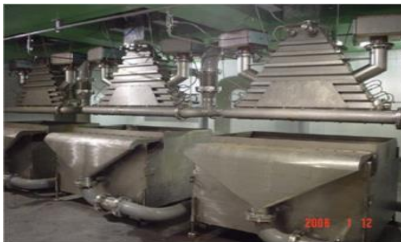
ภาพที่ 2.22 แสดงระบบบำบัดน้ำเสียด้วยเครื่องเร่งอเล็กตรอนเชิงเส้นในประเทศเกาหลีใต้ (ที่มา : ธีรพัฒน์ วิสัยทอง, 2560)
