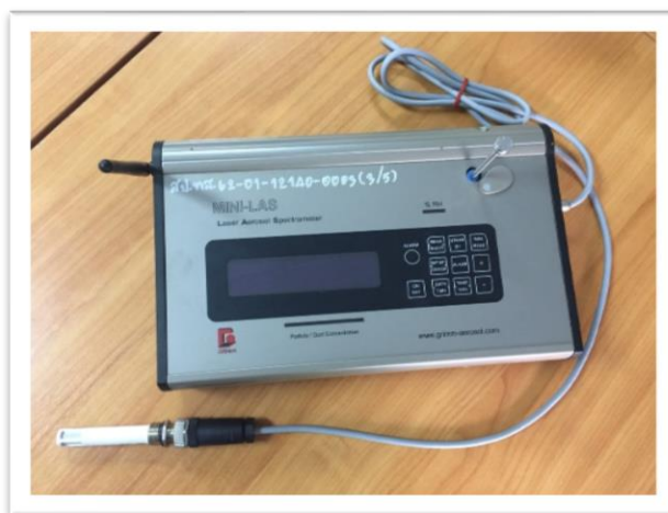
ภาพที่ 3 เครื่องมือเทคนิคการกระเจิงแสง Portable Laser Aerosol Spectrometer Model Mini-LAS 11E
