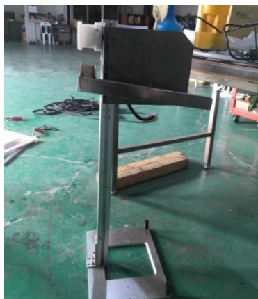
ภาพ 4.3 ประกอบชุดมอเตอร์เข้ากับฐาน ที่มา: บริษัท จี พาวเวอร์ เอ็นจิเนียริง จำกัด
