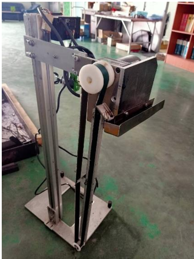
ภาพ 4.6 เครื่องแยกน้ำมันออกจากน้ำหล่อเย็น ที่มา: บริษัท จี พาวเวอร์ เอ็นจิเนียริง จำกัด
