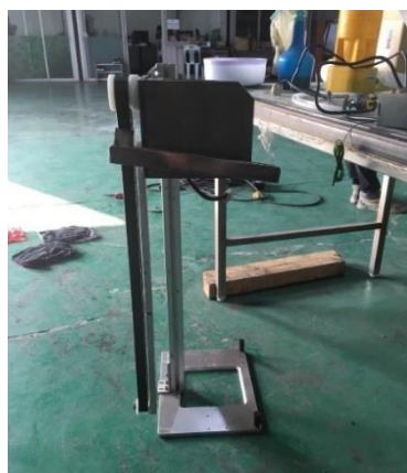
ภาพ 4.4 ติดตั้งที่ยึดปรับระยะกับมู่เลย์เล็กพร้อมใส่สายพาน ที่มา: บริษัท จี พาวเวอร์ เอ็นจิเนียริง จำกัด
