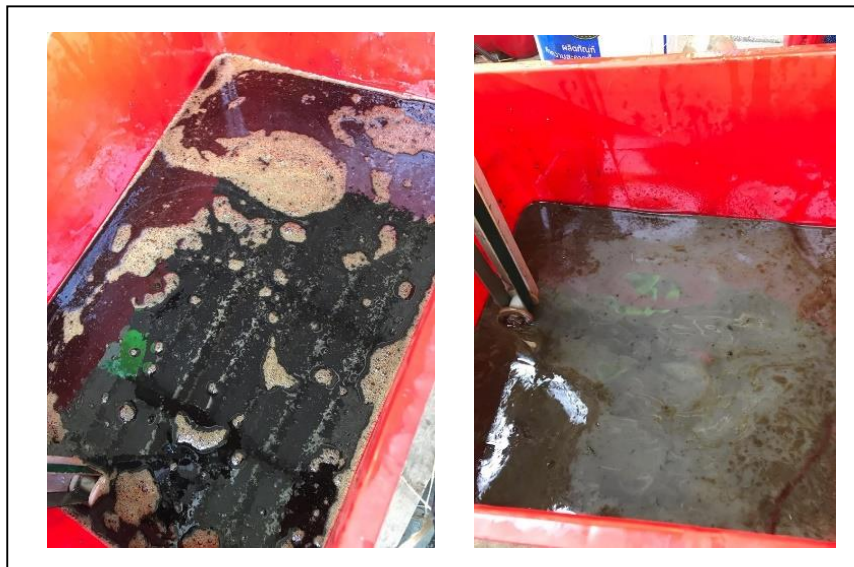
ภาพ 4.9 ก่อนและหลังทดลองแยกน้ำมันออกจากน้ำหล่อเย็น 30 ลิตร ที่มา: บริษัท จี พาวเวอร์ เอ็นจิเนียริง จำกัด
