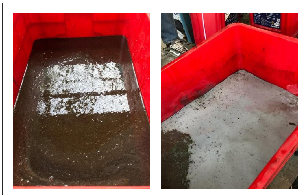
ภาพ 4.7 ก่อนและหลังทดลองแยกน้ำมันออกจากน้ำหล่อเย็น 10 ลิตร ที่มา: บริษัท จี พาวเวอร์ เอ็นจิเนียริง จำกัด
