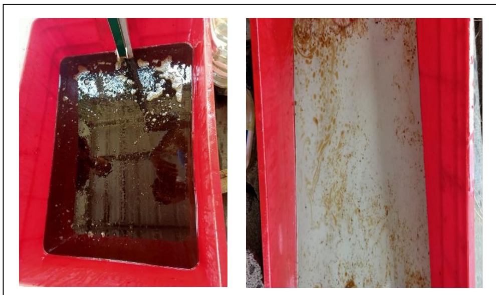
ภาพ 4.8 ก่อนและหลังทดลองแยกน้ำมันออกจากน้ำหล่อเย็น 20 ลิตร ที่มา: บริษัท จี พาวเวอร์ เอ็นจิเนียริง จำกัด
