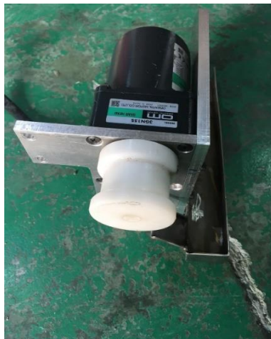
ภาพ 4.2 ประกอบมอเตอร์เข้ากับแผ่นอะลูมิเนียมพร้อมใส่มู่เลย์และตัวรีดน้ำมัน ที่มา: บริษัท จี เพาเวอร์ เอ็นจิเนียริง จำกัด
