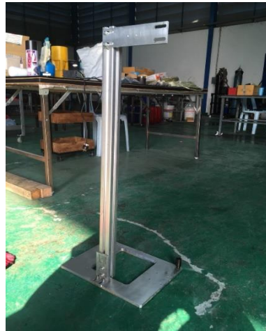
ภาพ 4.1 ประกอบโครงสร้างเครื่องแยกน้ำมันออกจากน้ำหล่อเย็น ที่มา: บริษัท จี เพาเวอร์ เอ็นจิเนียริง จำกัด
