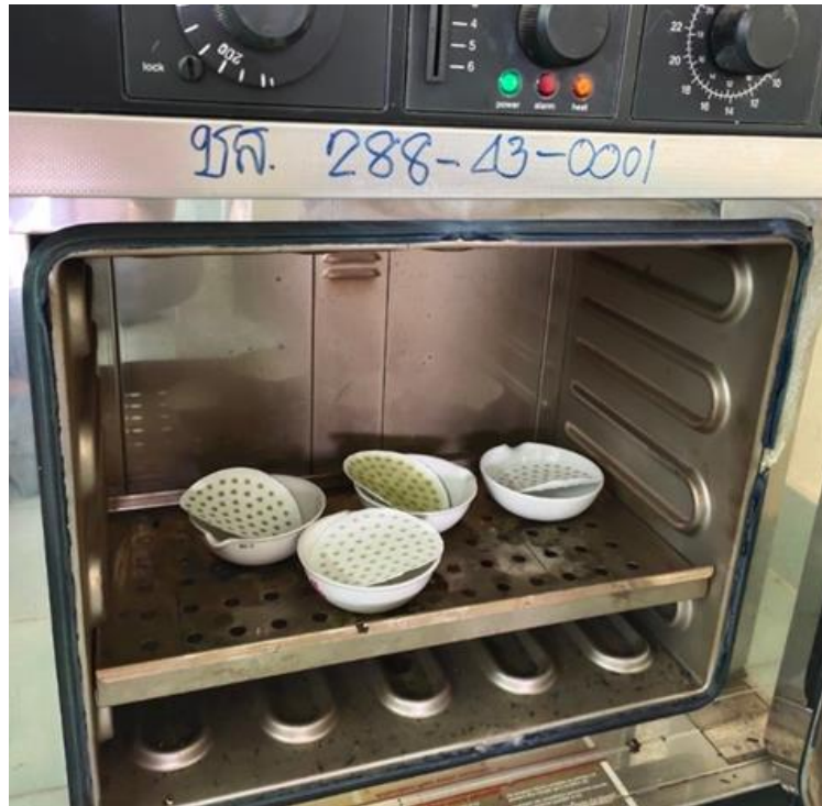
รูปที่ ก-34 นำแผ่นกระดาษกรองเข้าอบให้แห้งที่อุณหภูมิ 103-105 องศาเซลเซียส นาน 1 ชั่วโมง จน น้ำหนักคงที่แล้วนำไปชั่งอีกรอบและบันทึกผล
