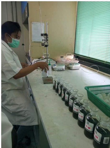
รูปที่ ก-23 ปล่อยสารโซเดียมไฮโอซัลเฟต ( \text{Na}_2\text{S}_2\text{O}_3 \cdot 7\text{H}_2\text{O} ) ลงไปในช่วงแก้วทีละหยด ต่อไปช้าๆ (อย่าลืมเขย่าขวดด้วย) กระสีน้ำเงินจางหายไปหรือน้ำในขวดมีสีใสๆ ให้หยุดปล่อยสารโซเดียมไฮโอซัลเฟต ( \text{Na}_2\text{S}_2\text{O}_3 \cdot 7\text{H}_2\text{O} ) ทันทีบันทึกปริมาณของสารโซเดียมไฮโอซัลเฟต ( \text{Na}_2\text{S}_2\text{O}_3 \cdot 7\text{H}_2\text{O} ) ที่ใช้ไปทั้งหมดในหน่วยมิลลิกรัม ซึ่งปริมาณออกซิเจนละลายน้ำจะเท่ากับปริมาณสารละลายโซเดียมไฮโอซัลเฟต ( \text{Na}_2\text{S}_2\text{O}_3 \cdot 7\text{H}_2\text{O} ) ที่ใช้ไปนั่นเอง
