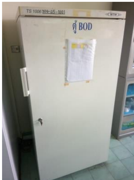
รูปที่ ก-12 ตู้BOD
