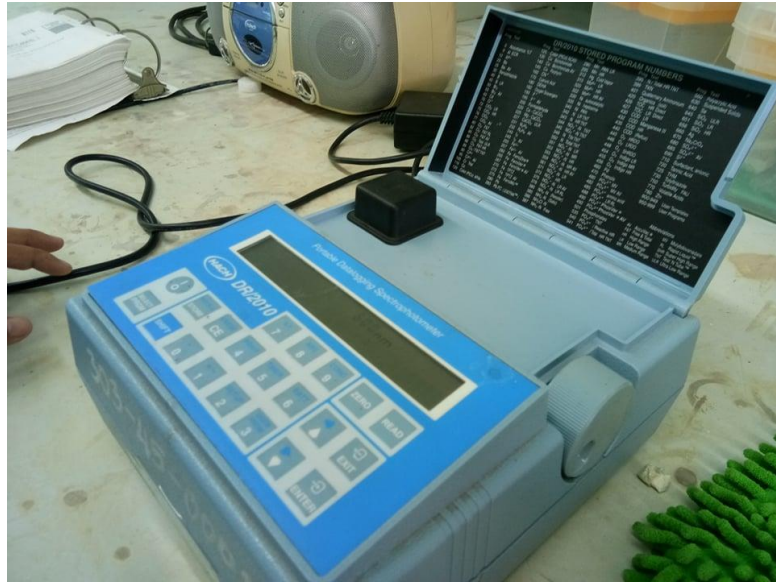
รูปที่ ก-29 วัดค่า COD ด้วย Spectrophotometer
