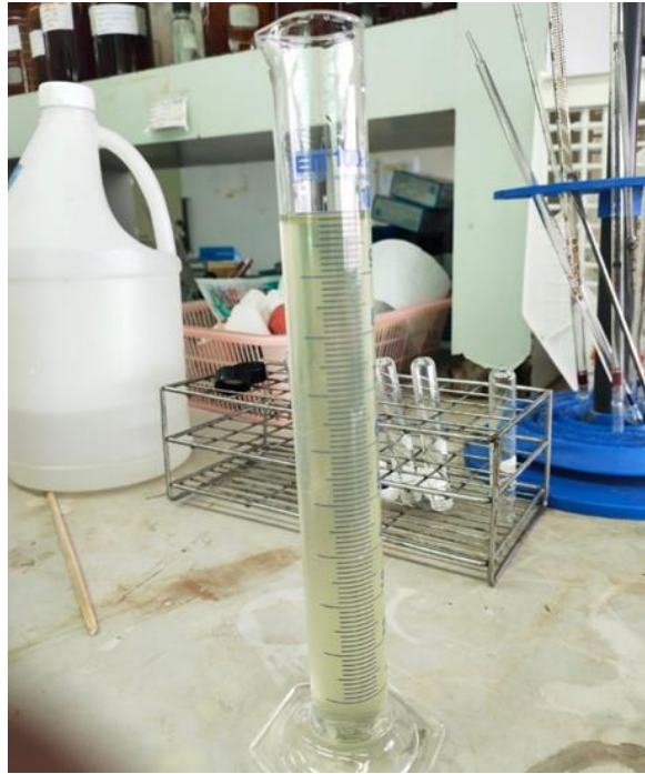
รูปที่ ก-32 นำน้ำตัวอย่างเทใส่กระบอกตวง 100 มิลลิลิตร
