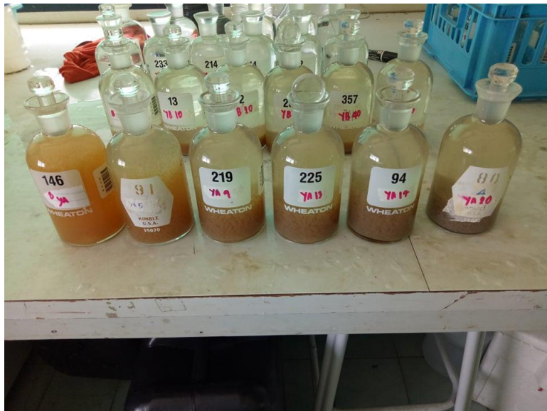
รูปที่ ก-20 สังเกตตะกอนที่เกิดขึ้น ถ้าตะกอนเป็นสีขาวแสดงว่าน้ำไม่มีออกซิเจนละลาย ให้ยุติการทดสอบ ถ้าสังเกตเห็นตะกอนสีน้ำตาล เกิดขึ้นในขวดให้ตั้งทิ้งไว้ให้ตกตะกอนประมาณ 2 ใน 3 ส่วน ของขวด
