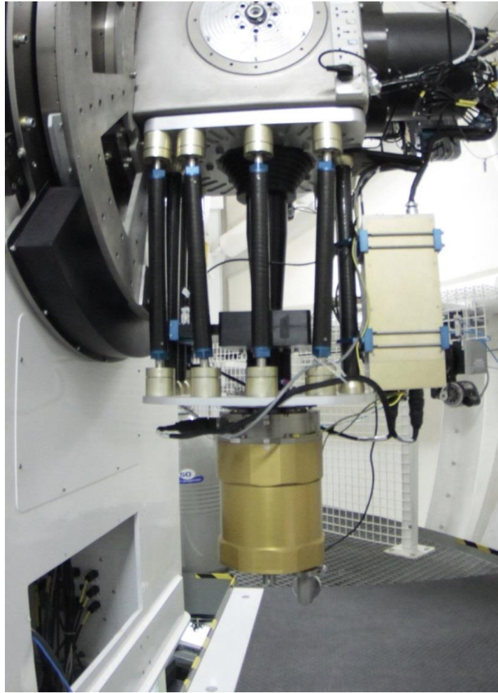
ภาพที่1.15 กล้องถ่ายภาพ ULTRASPEC ติดตั้งเข้ากับกล้องโทรทรรศน์ 2.4 เมตร
