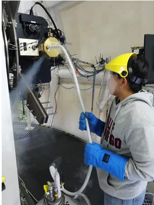
ภาพที่ ค.1 การเติมไนโตรเจนเหลว เพื่อหล่อเย็นซีดีดีซีบและเปลี่ยนถึงไนโตรเจนเหลว
