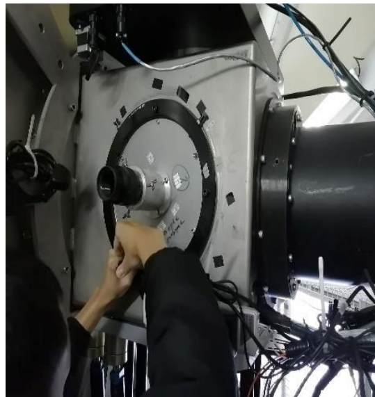
ภาพที่ ค.1 การเติมไนโตรเจนเหลว เพื่อหล่อเย็นซีดีดีซีบและเปลี่ยนถึงไนโตรเจนเหลว
