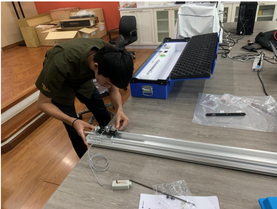
ภาพที่ ก.8 ติดตั้งชุดการทดลองยังโมดูลัส
