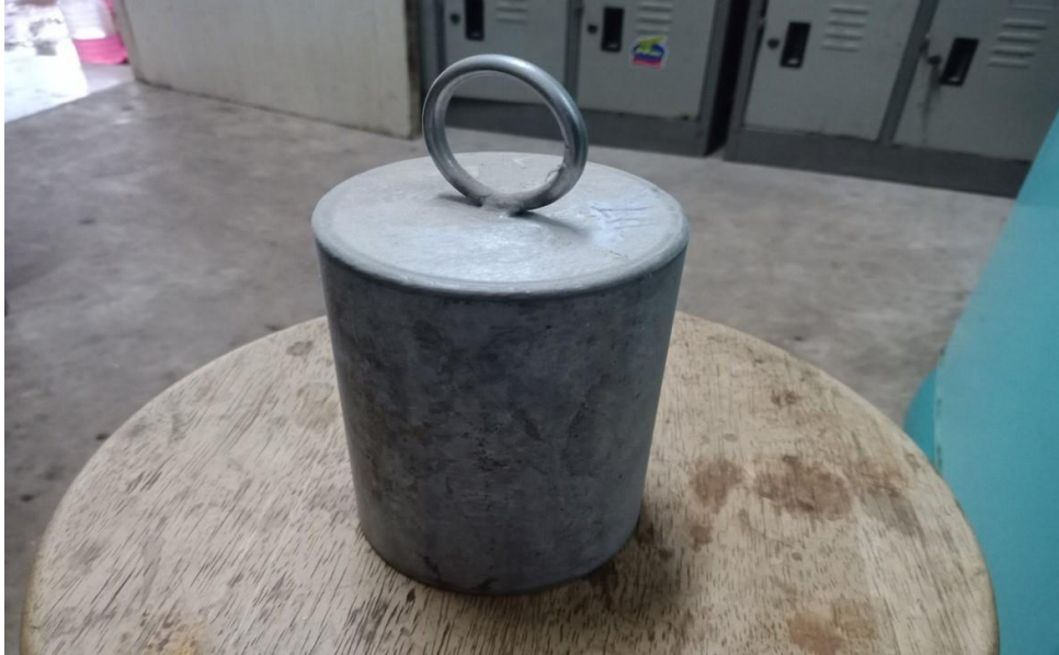
ภาพที่ 4.4 ลูกตุ้มถ่วงน้ำหนักขนาด 4.8 Kg
