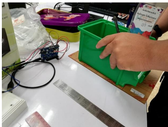
ภาพที่ 1 การประกอบอุปกรณ์เครื่อง ชั่งน้ำหนัก
