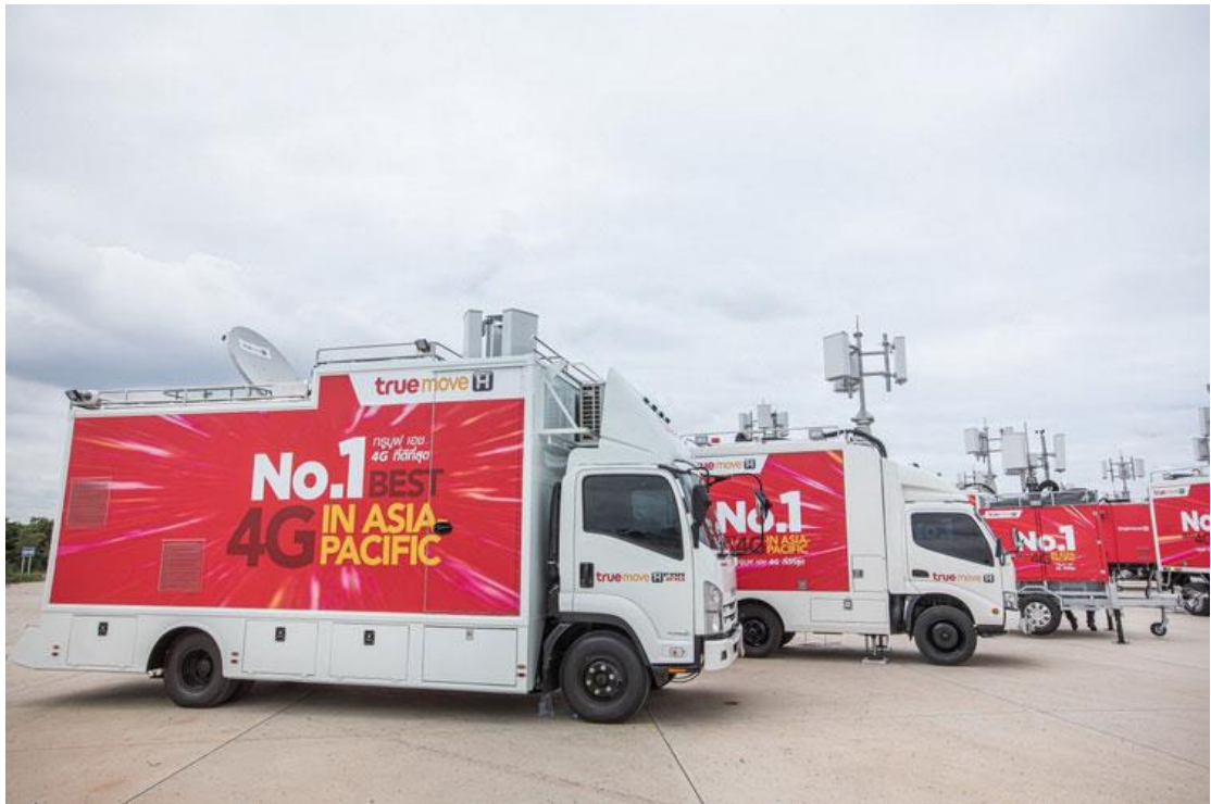
ภาพที่ xx รถCOW หรือ รถโมบายล์ชุมสายเคลื่อนที่เร็ว
