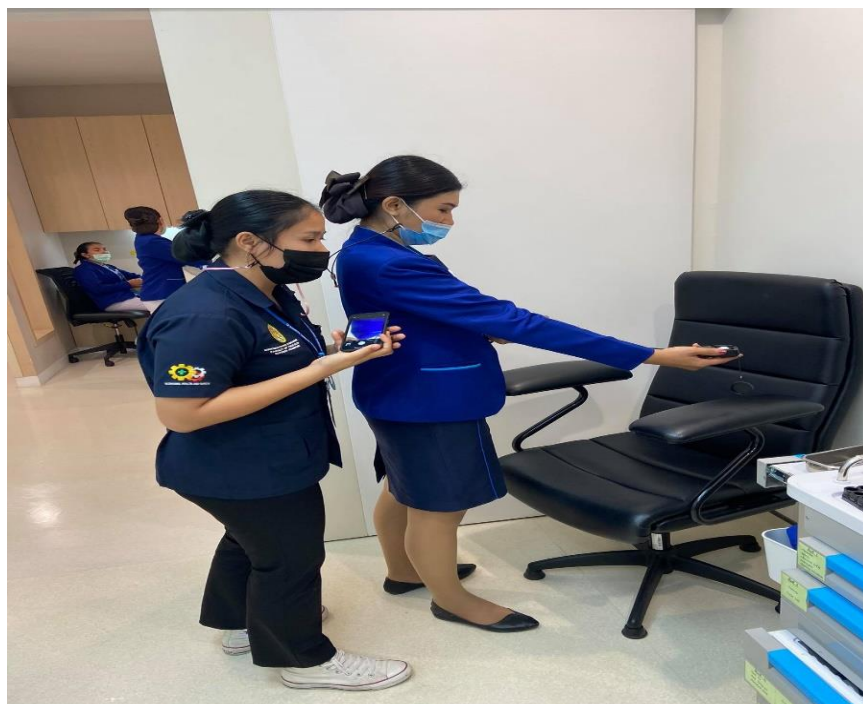
ภาพที่ 17 การตรวจเช็คแสงสว่างภายในห้องตรวจ
