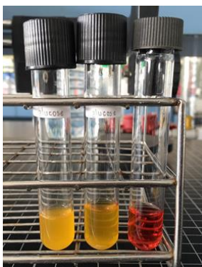
ภาพที่ 3.11 การเปลี่ยนสีของ phenol red glucose broth จากสีแดงเป็นสีเหลือง
