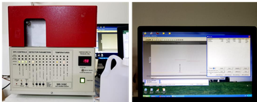
ภาพที่ 3.8 ตรวจวัดแก๊สเอทิลีนด้วยเครื่อง SRI 310C Gas Chromatograph
