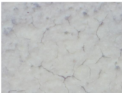
ภาพที่ 4.5 ความหนาของฟิล์มหมุนเหวี่ยง Step 1; 500 rpm 10 sec Step 2; 1,500 rpm 30 sec
