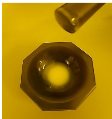
ภาพที่ 3.5 ผสมสารยึดเหนี่ยวกับวัสดุในโถรงบตสาร
