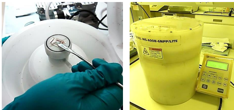
ภาพที่ 3.6 หยดสารละลายลงบนอิเล็กโทรดและทำการเคลือบด้วยเทคนิค Spin Coating
