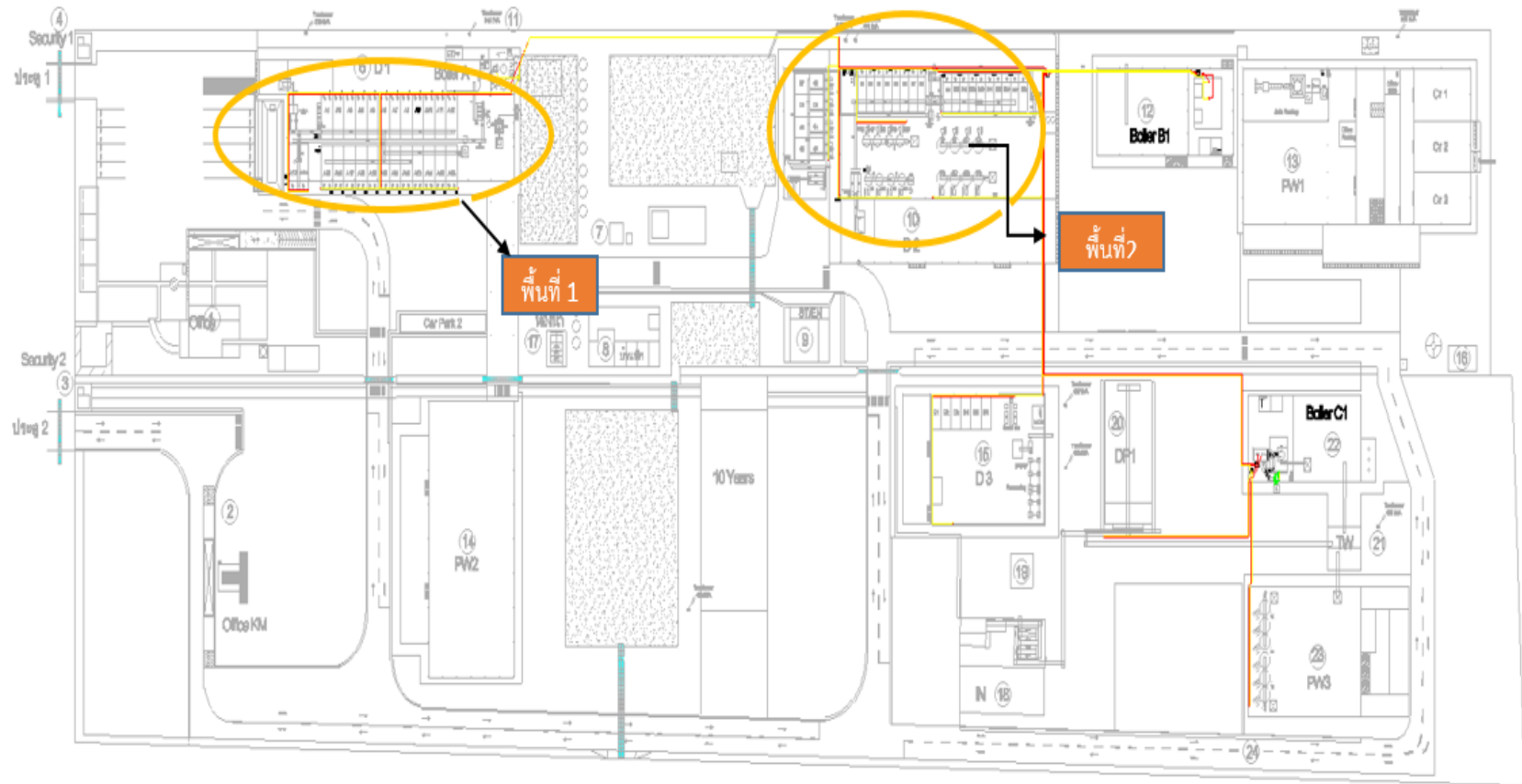
รูปที่ 3 แผนผังจุดติดตามตรวจสอบระดับเสียงเพื่อจัดทำแผนที่ระดับเสียงของโครงการ
