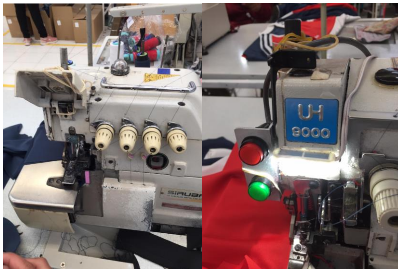
ภาพที่ 2-8 อุปกรณ์คุ้มครองอันตรายที่เครื่องจักร (Machine Guarding) (ก่อนตรวจ)
