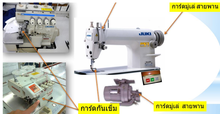
ภาพที่ 2-1 ตัวอย่างของเครื่องจักรเย็บผ้าที่มีการติดตั้งเซฟการ์ด
