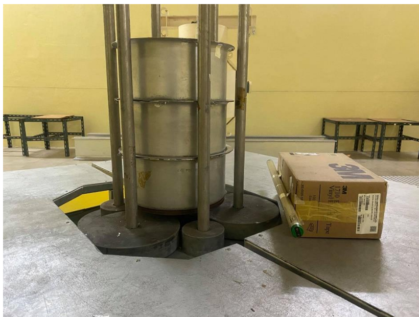
ภาพที่ 3.4 การฉายรังสีหลอดไฟฟลูออเรสเซนต์บริเวณรอบต้นกำเนิดรังสี
