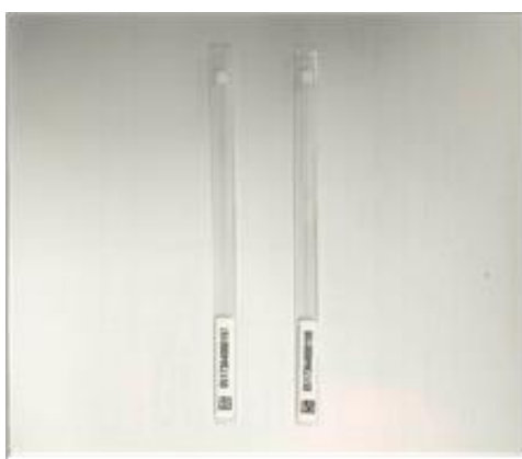
ภาพที่ 3.2 เป็นอุปกรณ์วัดปริมาณรังสีชนิด Alanine blister
