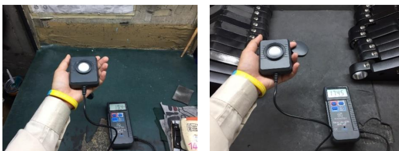
ภาพที่ 23 ตรวจวัดแสงสว่างในพื้นที่ปฏิบัติงาน
