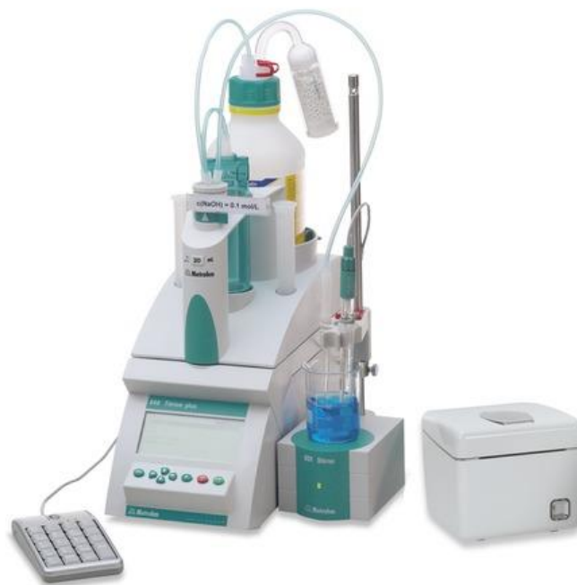
รูปที่ 2.2 เครื่องไทเทรตอัตโนมัติ ( รุ่น 848 Titrino plus )
