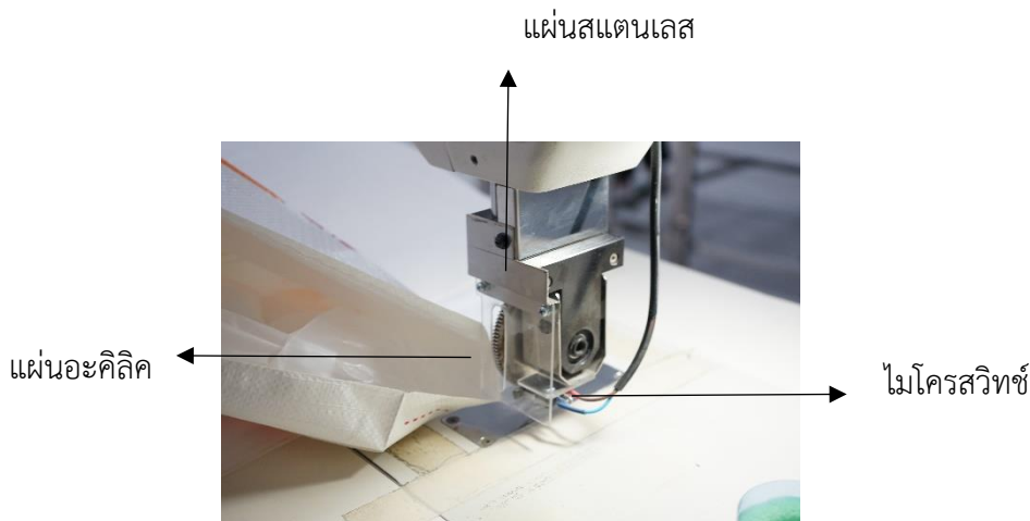
รูปที่ 1.20 วัสดุที่ใช้ทำ Stopper เครื่องซีลปาก
