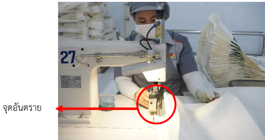
รูปที่ 1.21 จุดที่เป็นอันตรายของเครื่องซีลปาก
