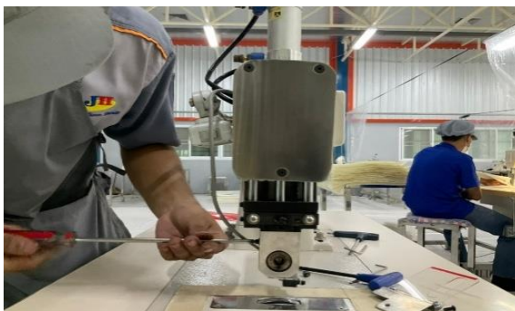
รูปที่ 1.28 กำหนดจุดยึดของลิมิตสวิตช์
