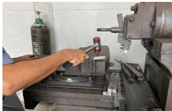
รูปที่ 1.24 การพับแผ่นสแตนเลสให้เป็นฉาก
