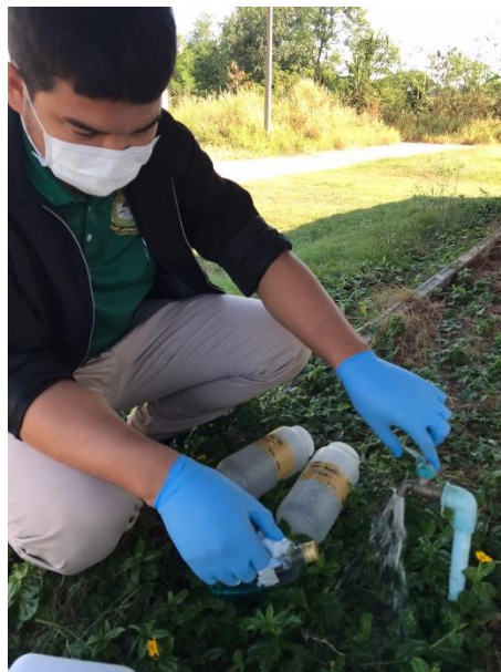
ภาพที่ 6 เปิดก๊อกน้ำให้ไหลเต็มที่นานประมาณ 1 นาที เพื่อระบายน้ำที่ค้างอยู่ในท่อน้ำทิ้ง
