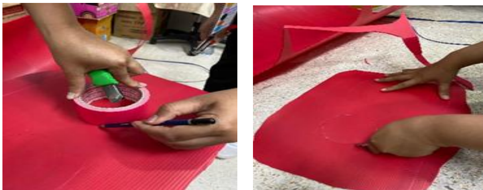
รูปที่ 3.7 การเตรียมเจาะรูบนกระดาษลูกฟูกที่มีขนาดเท่ากับฝาถัง จำนวน 3 ชิ้น
