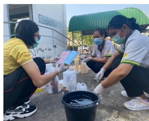
รูปที่ 3.29 ศึกษาวิธีการเก็บตัวอย่างน้ำเสีย และน้ำทิ้งจากระบบบำบัดน้ำเสียของ โรงพยาบาล
