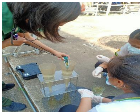
รูปที่ 3.37 ได้รับมอบหมายงานให้ศึกษาเรียนรู้ตรวจค่า TDS, ค่าpH ในบ่อเติมอากาศและเติมคลอรีนลงในบ่อสัมผัสคลอรีน
