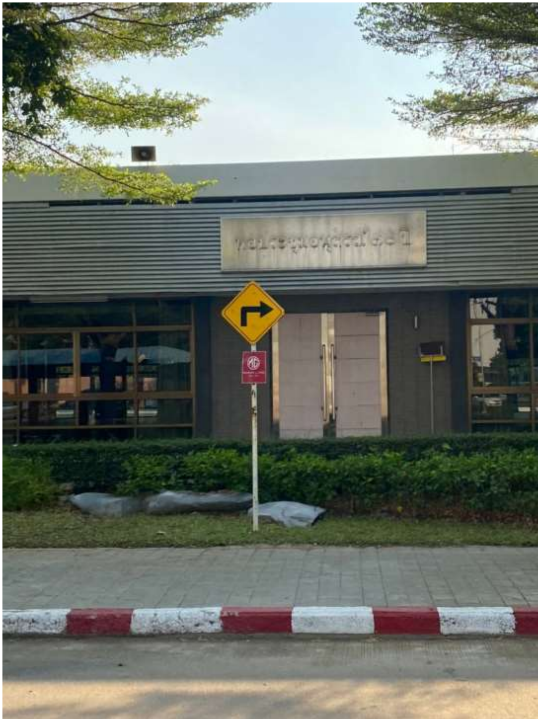
ภาพประกอบที่ 2 ป้ายทางโค้งรัศมีแคบเลี้ยวขวา
