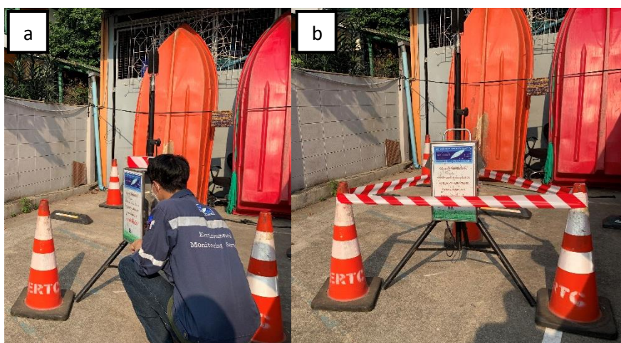
ภาพที่ 3.1 การตรวจวัดระดับเสียง (a) การตั้งค่าเครื่องตรวจวัดระดับเสียง, (b) ลักษณะการติดตั้งเครื่องตรวจวัดระดับเสียง
