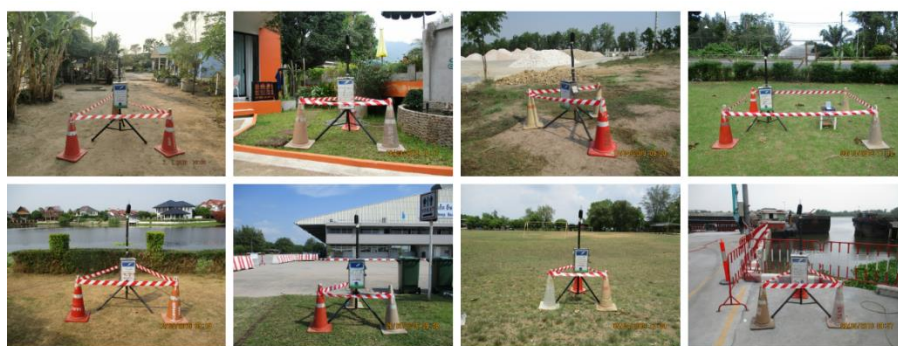
ภาพที่ 1.10 ลักษณะการตรวจวัดระดับเสียง และระดับเสียงรบกวน
