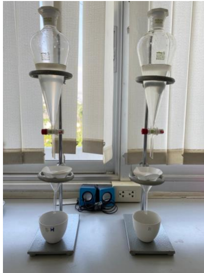
ภาพที่ 7 การจัดเครื่องมือวิธีการสกัดน้ำมันและไขมันด้วยกรวยแยก
