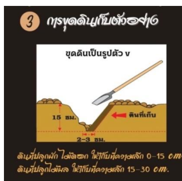
ภาพที่ 3 การขุดดินเก็บตัวอย่าง
