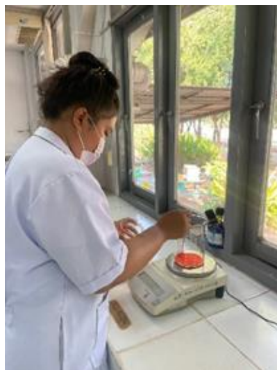
ภาพที่ 21,22,23,24 ซึ่งเตรียมสารละลายเฟอร์รัสแอมโมเนียมซัลเฟต และสารละลายโพแทสเซียมไดโคร
