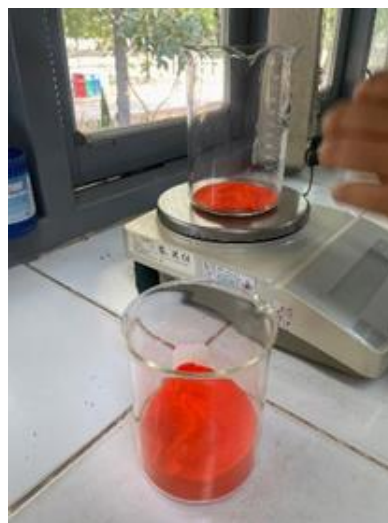
ภาพที่ 21,22,23,24 ซึ่งเตรียมสารละลายเฟอร์รัสแอมโมเนียมซัลเฟต และสารละลายโพแทสเซียมไดโคร
