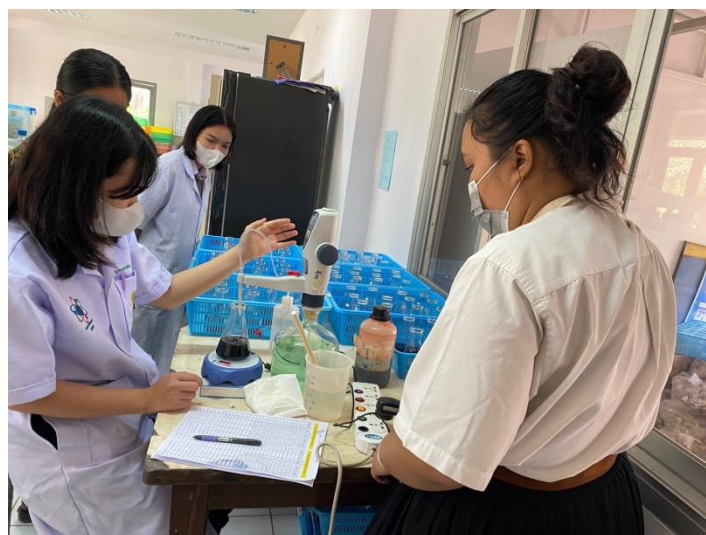
ภาพที่ 9,10,11 ไทเทรตด้วยสารละลายเฟอร์รัสแอมโมเนียมซัลเฟต
