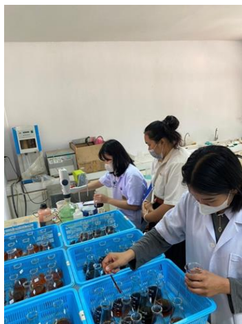
ภาพที่ 2.4 ไทเทรตด้วยสารละลายเฟอร์รัสแอมโมเนียมซัลเฟต
