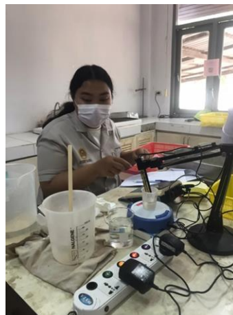
ภาพที่ 2.3 ใช้เครื่อง Ion Analyzer ซึ่ง Calibrate ด้วยสารละลายมาตรฐานโพแทสเซียมที่ความเข้มข้น 1 และ 10 มก./ลิตร
