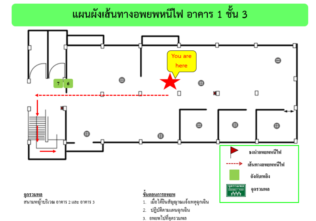
ภาพที่ 3.3 แผนผังจุดติดตั้งถังดับเพลิง อาคาร 1 ชั้น 3
