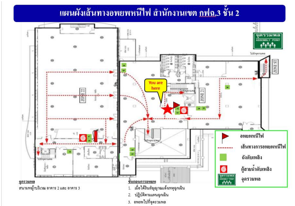
ภาพที่ 3.9 แผนผังจุดติดตั้งถังดับเพลิง อาคาร 3 ชั้น 2
