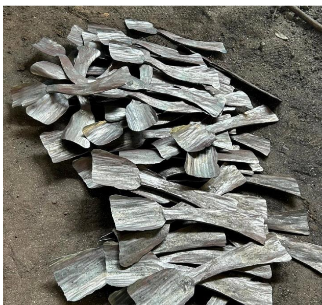
ภาพที่ 4 เป็นอีกหนึ่งขั้นตอนการหลอมเหล็กและใช้เครื่องไฮดรอลิกทุบเหล็กให้แบน
