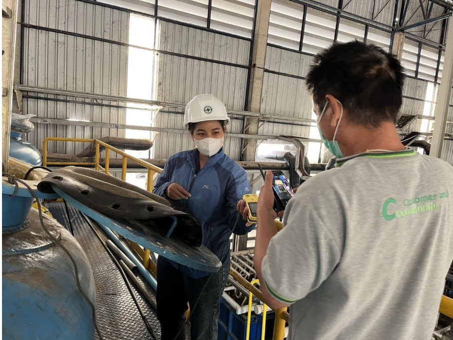
ตรวจวัดค่าออกซิเจนก่อนการทำงานในพื้นที่อับอากาศ
