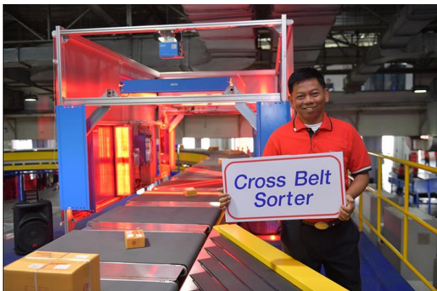
ภาพที่ 2.7 การคัดแยกพัสดุด้วย Cross Belt Sorter
