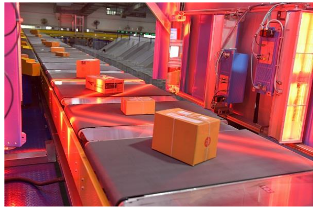
ภาพที่ 2.7 การคัดแยกพัสดุด้วย Cross Belt Sorter
