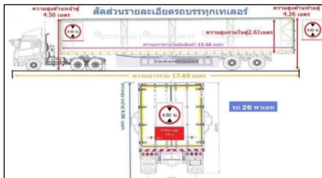
ภาพที่ 1.10 รายละเอียดรถบรรทุกเทเลอร์ (ที่มา: บริษัท ไทยเบเวอเรจแคน จำกัด)
