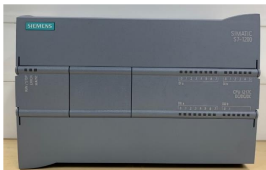
รูปที่ 3.6 PLC Siemens S7 1217 DC/DC/DC
