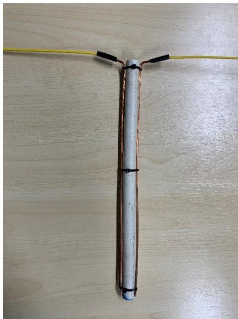
รูปที่ 3.13 นำแท่งทองแดงมายึดไว้กับท่อพีวีซีและยึดไว้ด้วยเคเบิลไทร์
