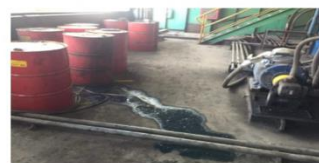
รูป ตัวอย่างสภาพการที่ไม่ปลอดภัย (สารเคมีรั่วไหล บริเวณทางเดิน)
