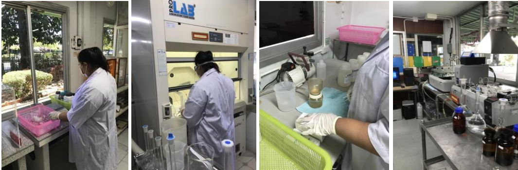
ภาพที่ 2.7 ชั่งสารเคมี,เตรียมสารเคมี,กรองตัวอย่าง เพื่อวิเคราะห์หา ไนโตรท์ ไนเตรทแอมโมเนีย ไนโตรเจน ด้วยเครื่อง Auto analysis
