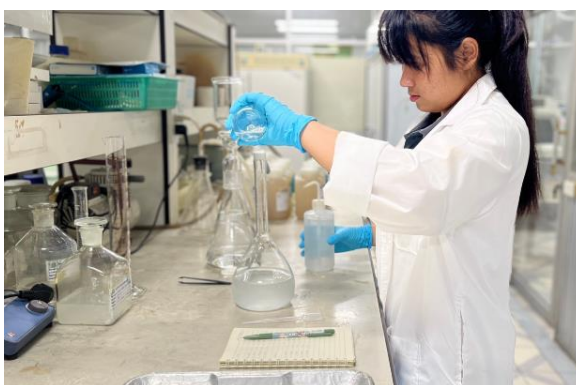
รูปที่ 2.36 ภาพการตรวจปริมาณของแข็งที่ละลายได้ในน้ำทั้งหมด (Total Soludle Solid)
