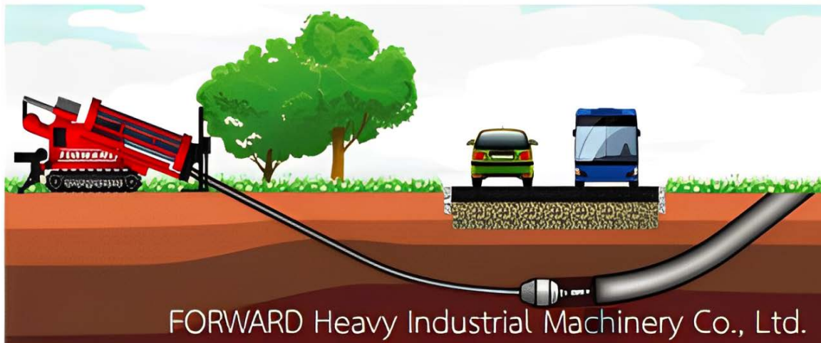
ภาพที่ 3.4 การวางท่อด้วยวิธีเจาะลอด (Horizontal Directional Drill : HDD)
