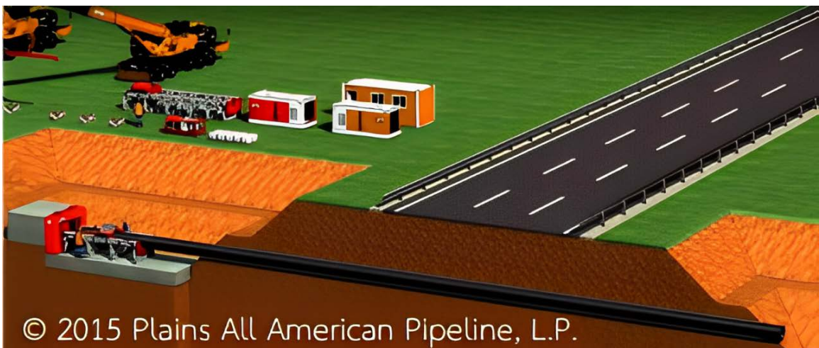
ภาพที่ 3.5 การวางท่อด้วยวิธีดันทลอด (Boring)
