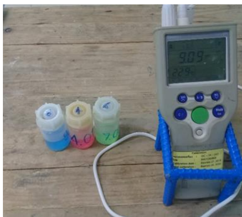
รูปที่ 5 อุปกรณ์ในการทวนสอบ (Calibrate) เครื่อง pH meter
