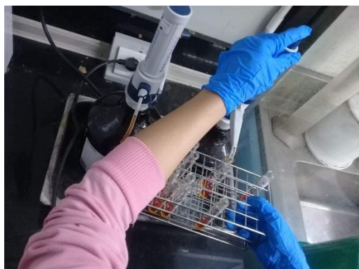
รูปที่ 7 สารละลายโพแทสเซียมไดโครเมต ( K_2Cr_2O_7 ) และกรดซัลฟิวริกเอเจนต์ (Sulfuric Acid Reagent) ใส่หลอดสำหรับทำซีไอดี
