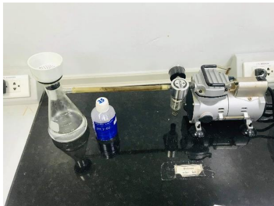
รูปที่ 8 อุปกรณ์ชุดกรอง เครื่องดูดอากาศ และกระดาษกรองใยแก้ว(GF/C)
