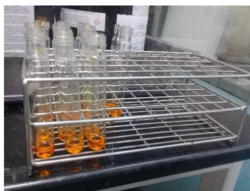
รูปที่ 7 สารละลายโพแทสเซียมไดโครเมต ( K_2Cr_2O_7 ) และกรดซัลฟิวริกเอเจนต์ (Sulfuric Acid Reagent) ใส่หลอดสำหรับทำซีไอดี
