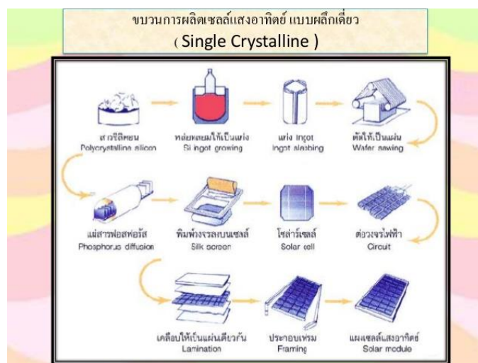
ภาพที่ 2.3 การผลิตเซลล์แสงอาทิตย์แบบผลึกเดี่ยว
