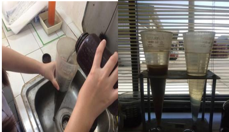
ภาพที่ 3 แสดงการวัดค่าการตกตะกอน โดยกรวยอิมฮอฟฟ์ ( V_{30}/V_{60} )
