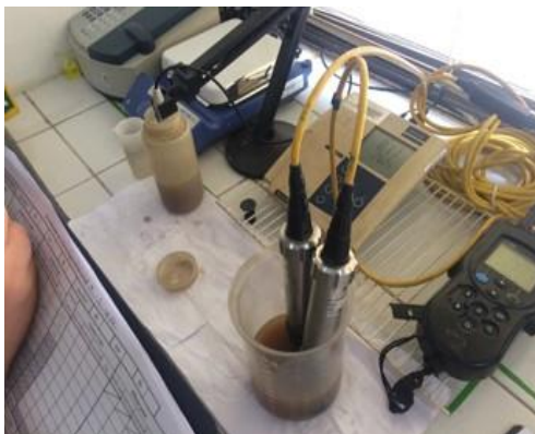
ภาพที่ 2 แสดงการวัดค่า pH , Temp , TDS, และ DO ณ ห้องปฏิบัติการสิ่งแวดล้อม
