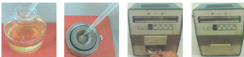
รูปที่ 3.3 ขั้นตอนการวัดค่าจุดวาบไฟของตัวอย่างน้ำมันเชื้อเพลิงดีเซล ชนิด B20
