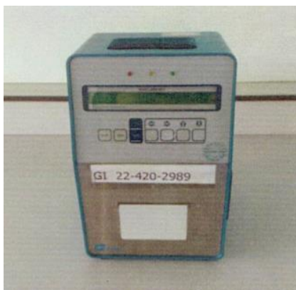
รูปภาคผนวก ก ที่ 2 เครื่องหาจุดวาบไฟในน้ำมันดีเซลภาคสนาม รุ่น MINIFLASH - FLP
