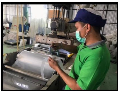
5.2 วัดความหนาของแผ่น Material เพื่อดูขนาดให้ได้ตามที่ต้องการ
