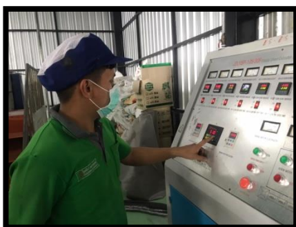
5.3 เก็บพิวงาน เพิ่มความเร็วของลูกกลิ้งให้เหมาะสมกับชิ้นงาน
