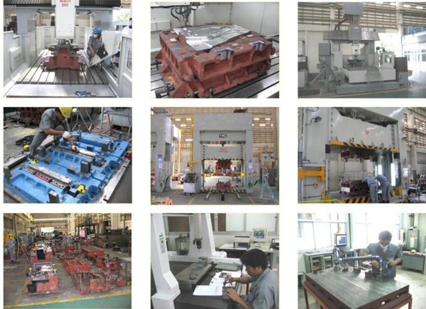
รูปภาพที่ 3 แม่พิมพ์เพื่อปั๊มชิ้นส่วนชิ้นรูปโลหะ และปั๊มชิ้นส่วนยานยนต์ทุกชนิด
